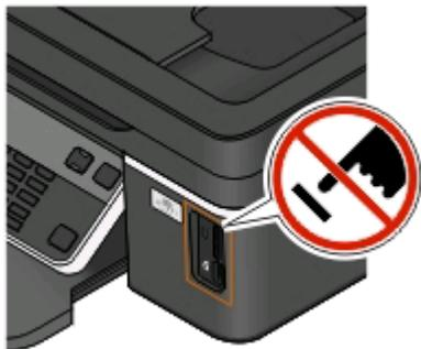
**Advertencia—Posibles daños:** No manipule ningún cable, adaptador de red, conector, dispositivo de memoria ni la impresora en las zonas que se muestran mientras esté imprimiendo, leyendo o escribiendo en el dispositivo de memoria. Se produce una pérdida de datos.
