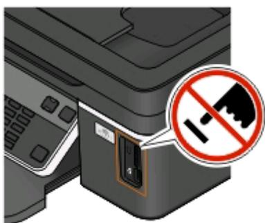
**Advertencia—Posibles daños:** No manipule el cable USB, adaptador de red, conector, dispositivo de memoria ni la impresora en las zonas que se muestran mientras esté imprimiendo, leyendo o escribiendo en el dispositivo de memoria. Se puede producir una pérdida de datos.
